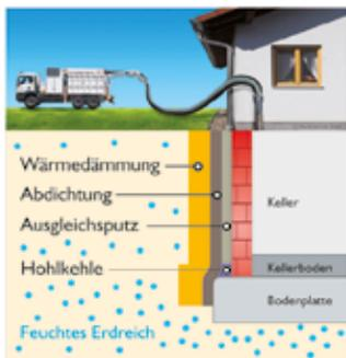
Wo früher eine große Baustelle notwendig war, kommt heute der Saugbagger zum Einsatz: Zum Schützen eines Hauses vor eindringendem Wasser wird bis zur Grundplatte ein Arbeitsschlitz neben dem Haus benötigt. Dieser wird elegant und schonend für Hof und Garten durch den Saugbagger ausgesaugt. Dann werden die Außenwände und die Hohlkehle zum Beispiel mit einer Bitumenschicht dauerhaft
