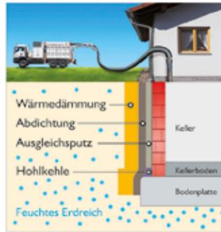
Wo früher eine große Baustelle notwendig war, kommt heute der Saugbagger zum Einsatz: Zum Schützen eines Hauses vor eindringendem Wasser wird bis zur Grundplatte ein Arbeitsschlitz neben dem Haus benötigt. Dieser wird elegant und schonend für Hof und Garten durch den Saugbagger ausgesaugt. Dann werden die Außenwände und die Hohlkehle zum Beispiel mit einer Bitumschicht dauerhaft
